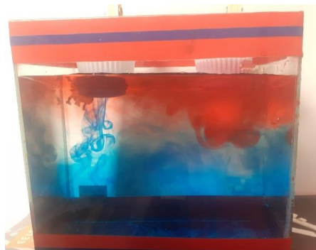
Figura 15. Experimento de propagação de calor por convecção.
