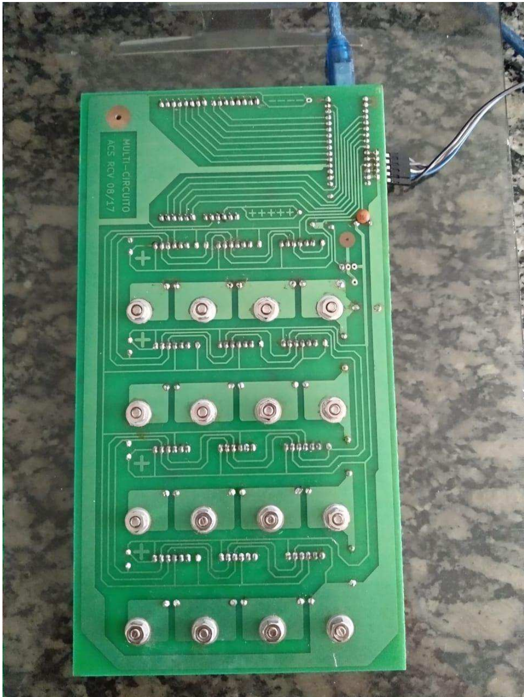
Figura 2.14 – Imagem da Placa de Circuito Impresso para o Multi-Circuito com os Componentes Soldados.
