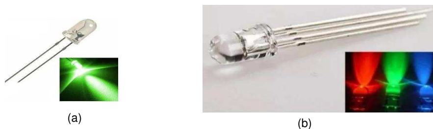
Figura 1.6 - Imagem (a) LED emitindo na cor verde, e (b) um LED RGB.
