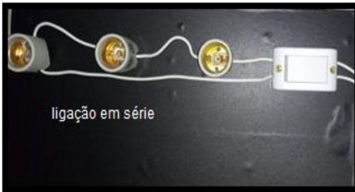
Figura 3.8 - Imagem fotográfica da ligação em série
