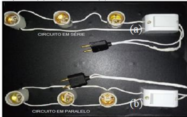
Figura 3.3 - Imagem fotográfica de um dos aparatos experimentais que será utilizado na aula 04, lâmpadas (a) em paralelo e (b) em série.
