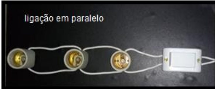
Figura 3.7 - Imagem fotográfica da ligação em paralelo
