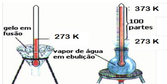
Figura 20 - Imagem representando o ponto de fusão, ebulição da água em (K) e o intervalo entre os pontos fixos.
