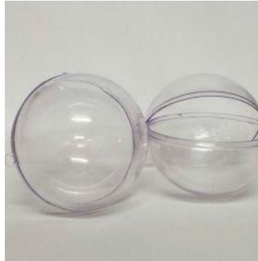
Figura 1.1. Foto da bola de acrílico com diâmetro de 15 cm.
