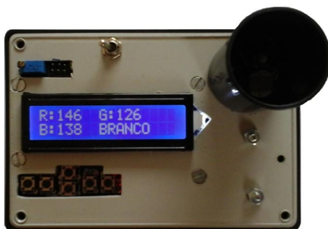
Figura 1.9 Protótipo do olho humano, segunda parte, função dos cones na identificação de cores.
