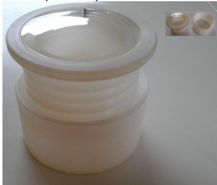
Figura 1.6 Foto do Focalizador, confeccionado no torno, feito de tubo de Tecnil com medidas (80x40x10)mm, de forma que ao ser rosqueado movimenta a lente, focalizando a imagem.
