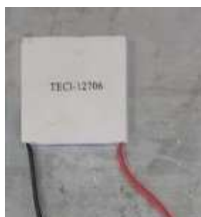
Figura C.14 – Imagem fotográfica de uma pastilha Peltier - modelo – TEC1-12706 que foi usado no presente trabalho.
