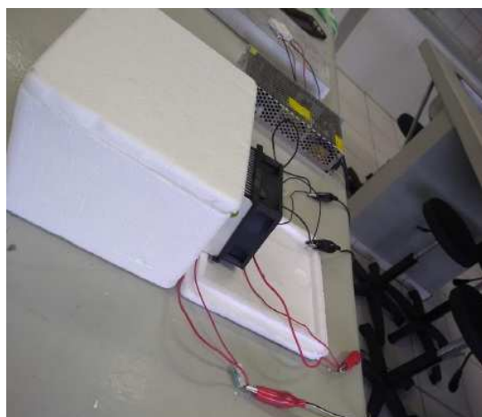
Figura 2.4 - Imagem fotográfica do Protótipo do refrigerador (a) tampado e com a fonte de tensão ao lado e (b) em destaque aberto (ESTÁGIO 4).
