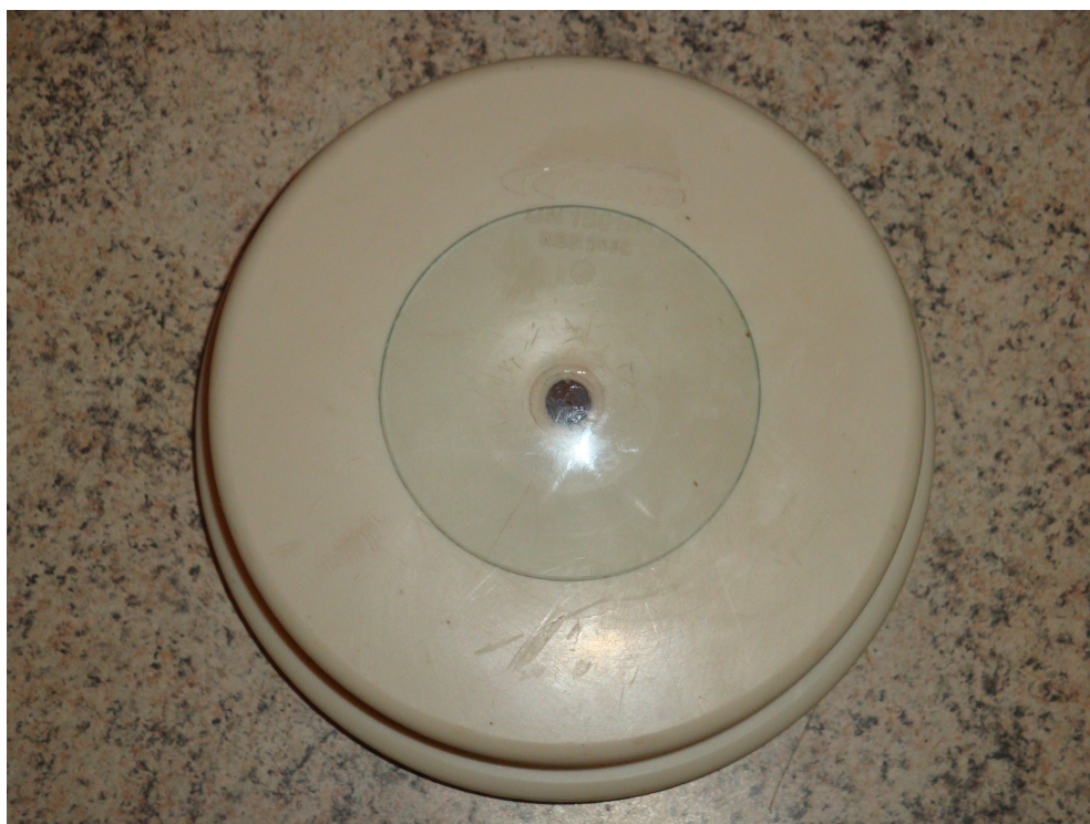
Figura 4 - Cap superior de PVC para 150mm, com o furo chanfrado, íris de plástico escuro rígidos (furo de 1mm) e cúpula de vidro transparente (vidro de relógio usado em laboratórios de química).
