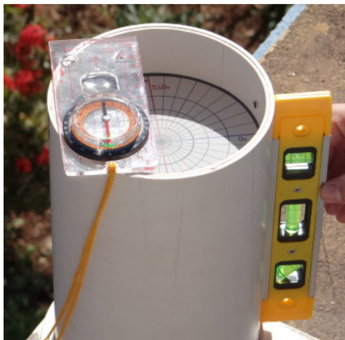
Figura 9 - Alinhamento do gabarito (norte-sul) e do tubo (vertical).
