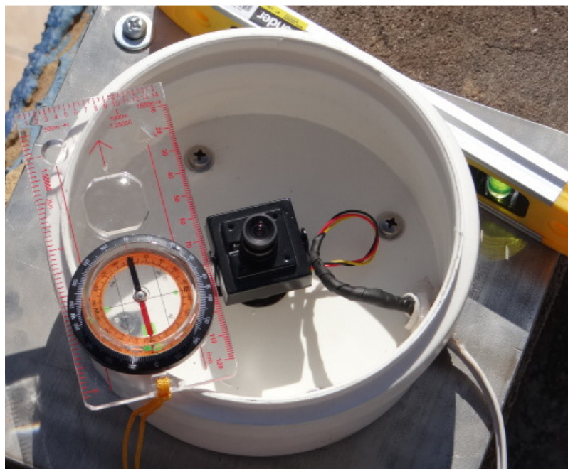
Figura 8 - Alinhamento da câmara (norte-sul) e da base de alumínio (horizontal).
