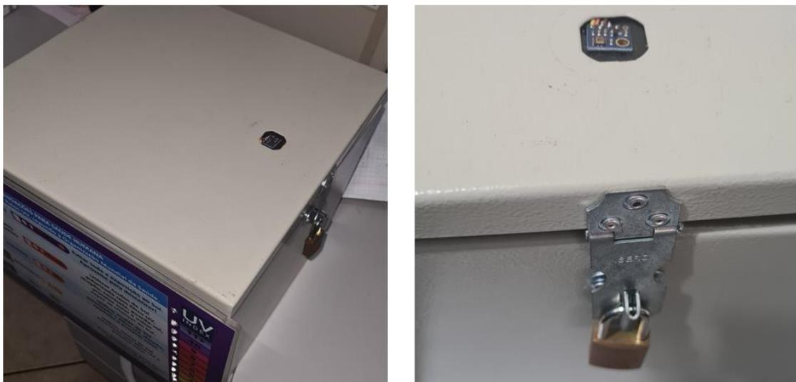
Figura 12: Imagens fotográficas da tampa com o sensor instalado e com a nova fechadura.
