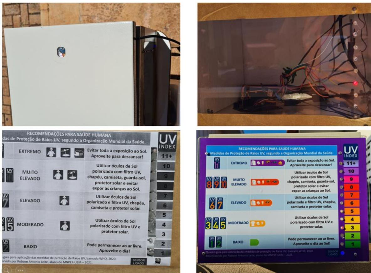
Figura 10: Imagens fotográficas: (em cima, esquerda) caixa vista de cima mostrando o orifício com o sensor; (em cima, direita) eletrônica: led, cabos e Arduino; (abaixo) parte frontal do equipamento em preto e branco (desenvolvimento) e final em colorido.
