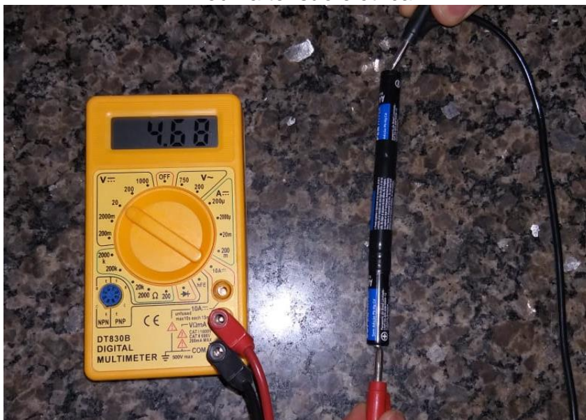
Figura 3.1 - três pilhas, de 1,5 volts, conectadas em série, e um multímetro para medir a tensão elétrica
