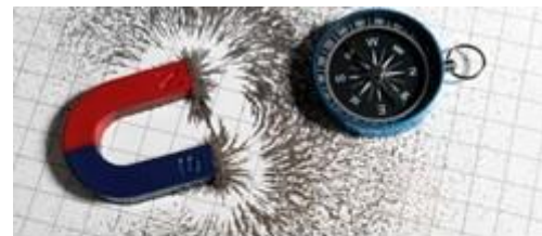
Figura 9 – Limalha de ferro sendo atraída pelos diferentes pólos magnéticos de um ímã
