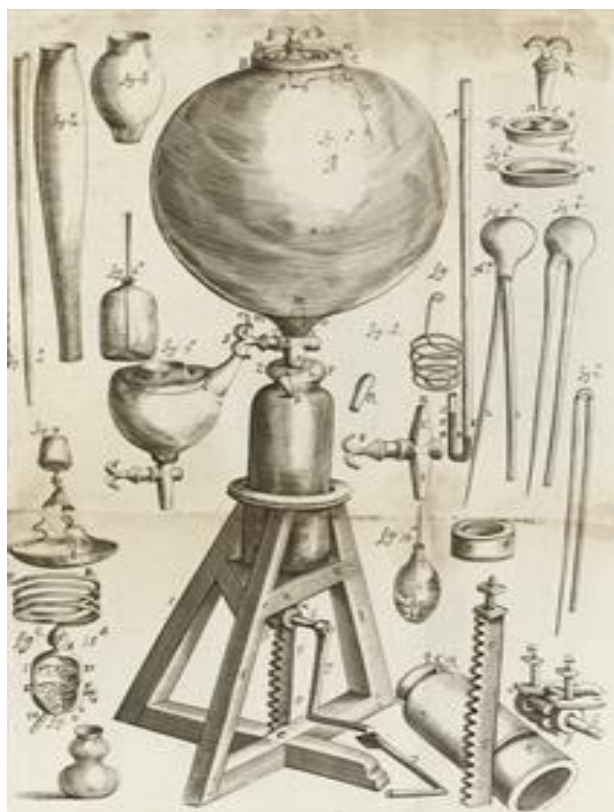
Figura 15: Bomba de ar de Boyle, projetada e construída por Robert Hooke.
