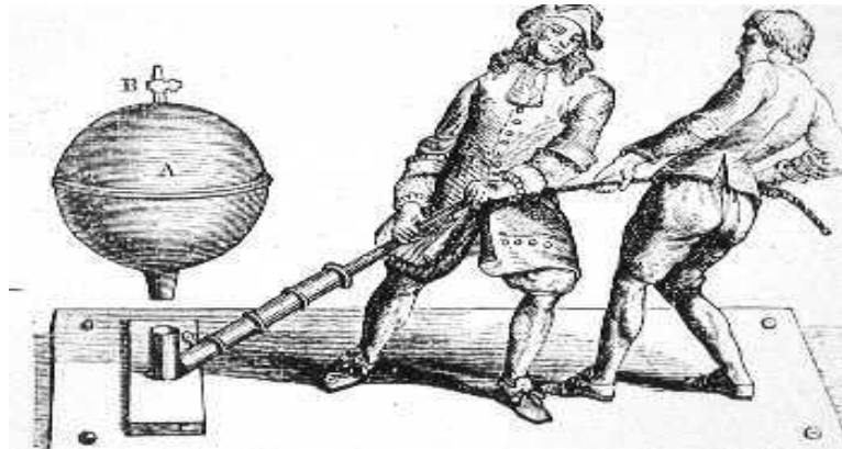
Figura 10: Bomba de Von Guericke sendo utilizada para remoção do ar de uma esfera de cobre.
