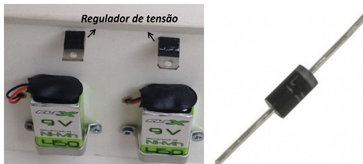
Figura 8– a) Diodos com a função de Regulador de tensão (6,0 V) e bateria; b) Diodos Zener.
